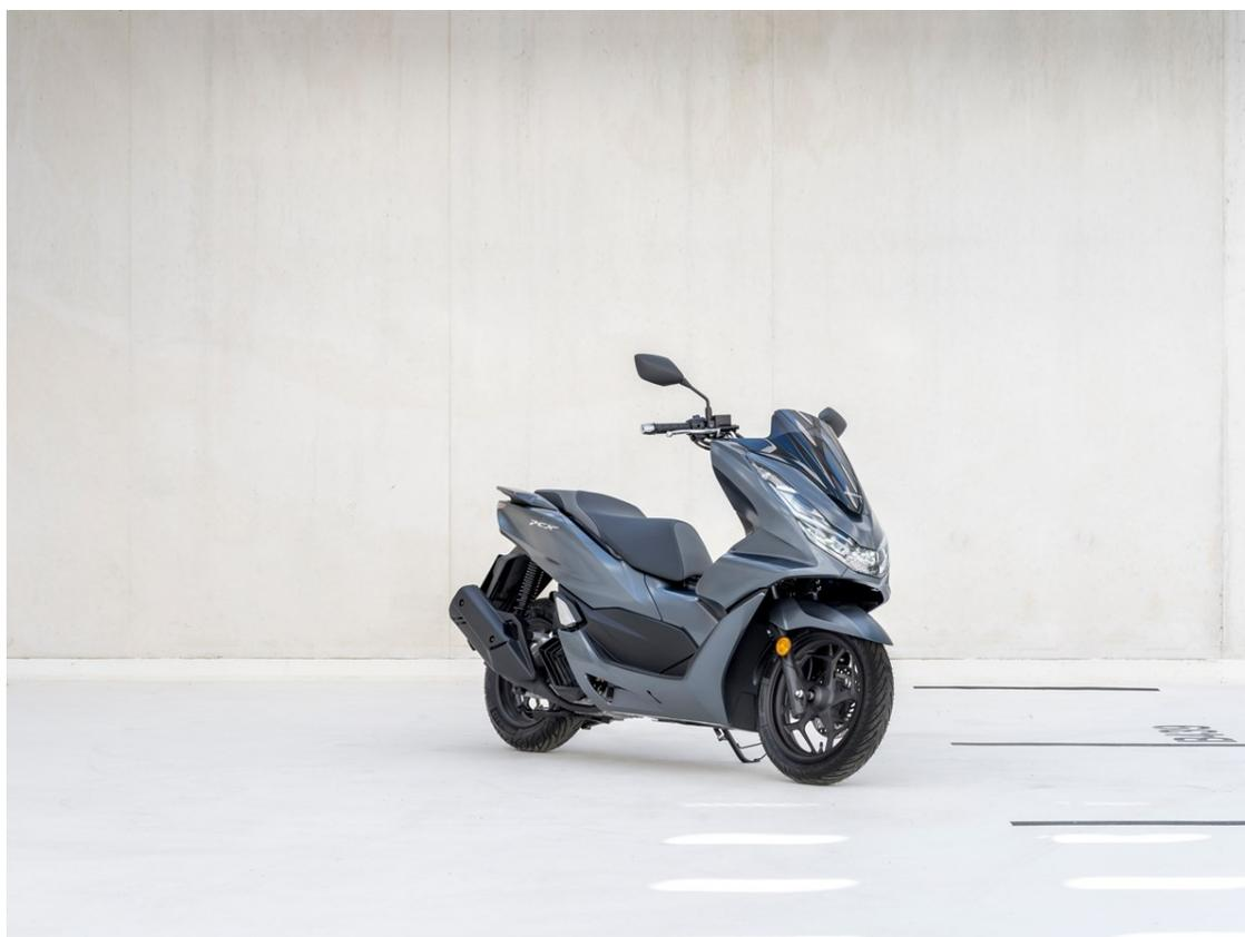
Le populaire PCX125 s'offre une robe plus contemporaine, un coffre plus volumineux, une prise USB-C et un système de démarrage sans clef Smart Key. Les performances sont en hausse grâce à un nouveau moteur monocylindre 4 soupapes Smart Power Plus (eSP+) conforme aux normes Euro 5 et équipé du système de contrôle de couple HSTC. Redessiné, le cadre profite de débattements de suspension arrière augmentés et de pneumatiques plus larges.
